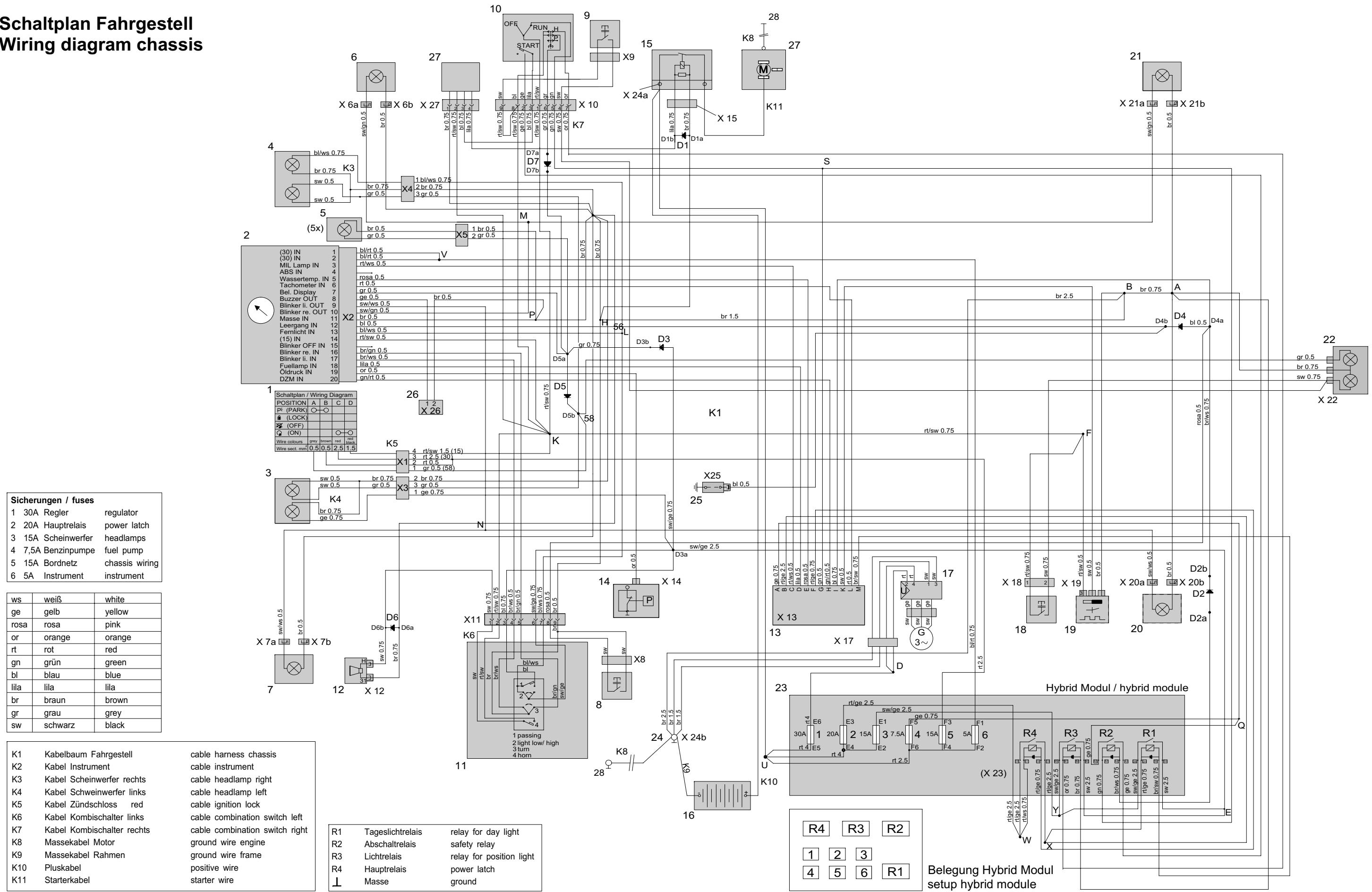
**Schaltplan Fahrgestell / Wiring diagram chassis**
